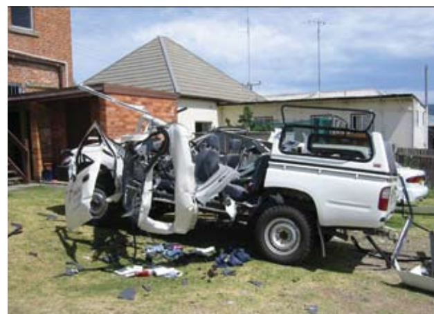
Les conséquences d'une explosion causée par l'accumulation de gaz inflammable dans un véhicule.
