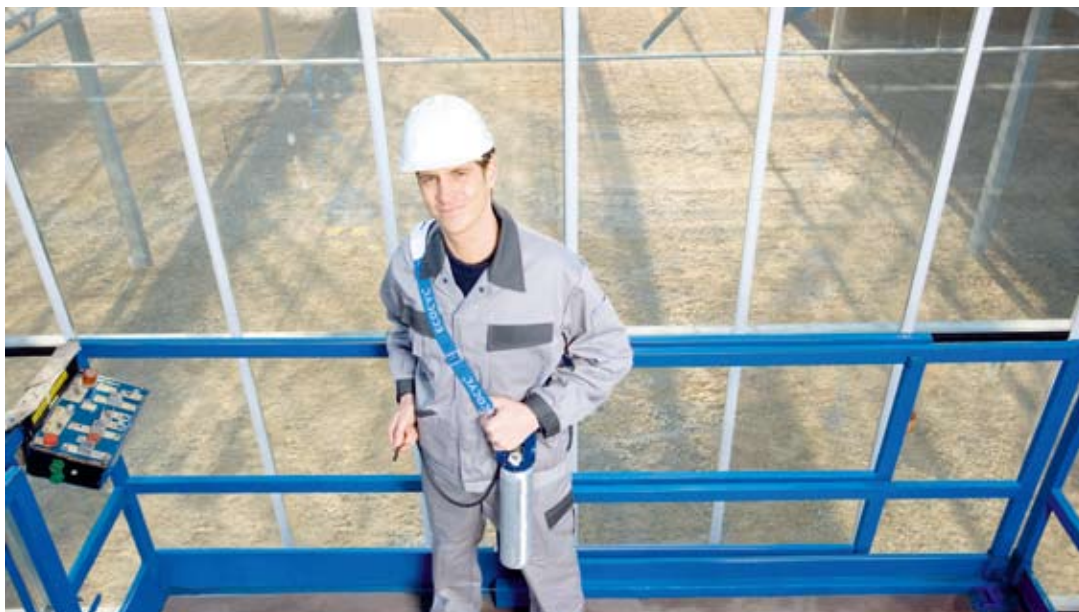
La bandoulière vous permet de porter ECOCYL MD lors de vos longues sessions de calibrage des capteurs fixes.
